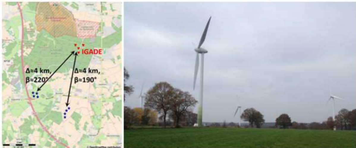
Abbildung 2: Windkraftanlagen (hier: vier Enercon 1800 kW südwestlich von IGAD E, in Betrieb seit 2005) in 4 km Umkreis zum Infrasschall-Array IGAD E nördlich von Bremen. Vier weitere Anlagen in südlicher Richtung wurden 2006 errichtet Quelle: BGR
