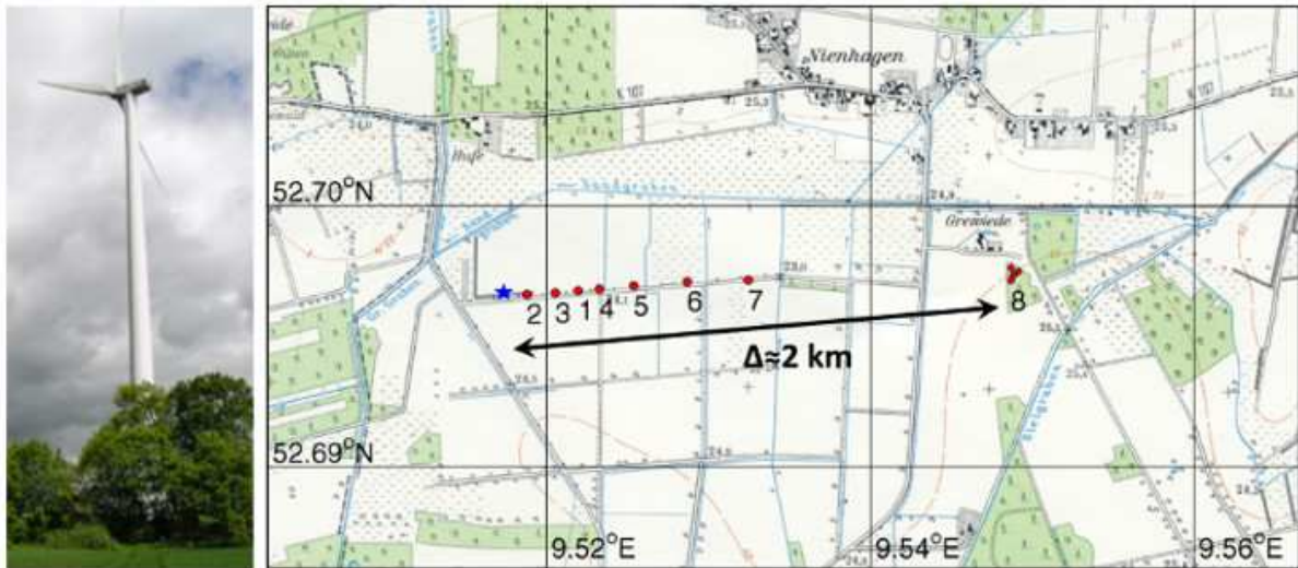
Abbildung 1: Feldmessungen an einer 200 kW Windkraftanlage vom Typ Vestas V47 nördlich von Hannover. Die Registrierung mit MB2000 Mikrobarometern erfolgte entlang eines etwa 2 km langen Profils Quelle: BGR
